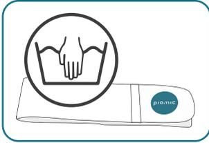
Das an einem Patienten wiederverwendbare Band COMS-refix kann von Hand mit nicht scheuernden, handelsüblichen Handwaschmitteln gereinigt werden. Nach dem Waschen bitte zum Trocknen aufhängen. Das Band sollte weder im Trockner getrocknet noch mit dem Bügeleisen gebügelt werden.
