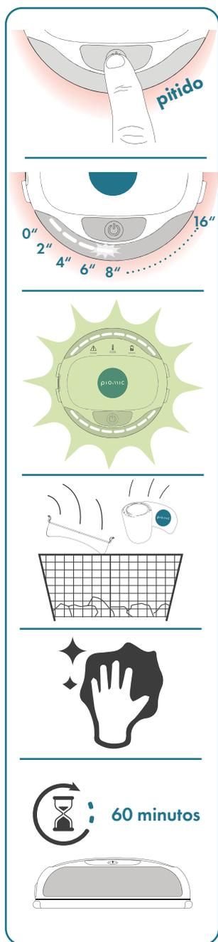
7. Pulse brevemente el botón de encendido y apagado (menos de 1 s) para iniciar el tratamiento. Se escucha un solo pitido y se observa un destello rojo en la parte inferior del aparato.
