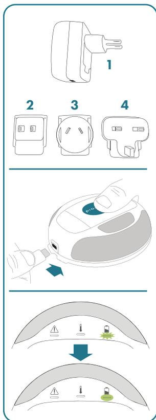
2. Branchez le chargeur dans une prise électrique murale et reliez le câble USB au bloc d'alimentation COMS One et au dispositif médical COMS One.
